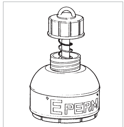
Figure 7 : Chambre d'ionisation avec électret
